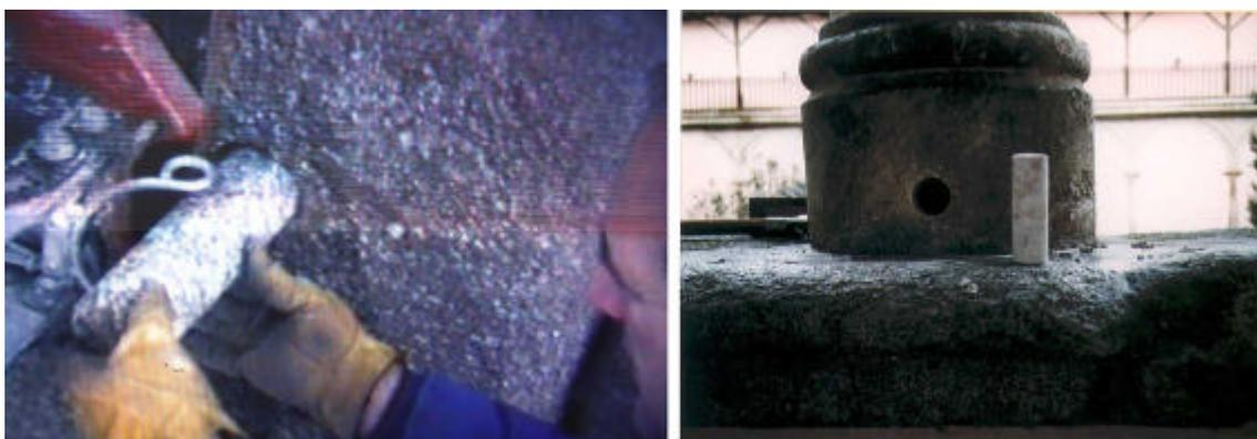
Obtención de testigos en los sillares graníticos del Acueducto de Segovia para su estudio y comparación con el extraído de canteras similares. A la derecha, testigos de las columnas de mármol de un claustro para determinar su seguridad ante las cargas soportadas.
